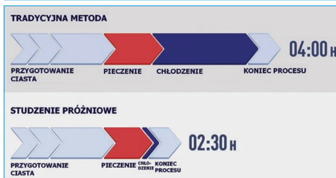
■ Porównanie czasów produkcji pieczywa w tradycyjnej technologii i technologii studzenia próżniowego.
